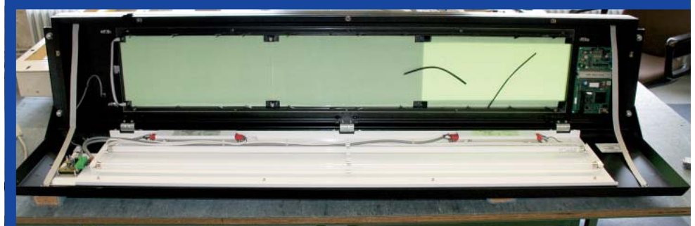
Bei dieser LCD-Version sorgen Leuchtstoffröhren für die Beleuchtung.
